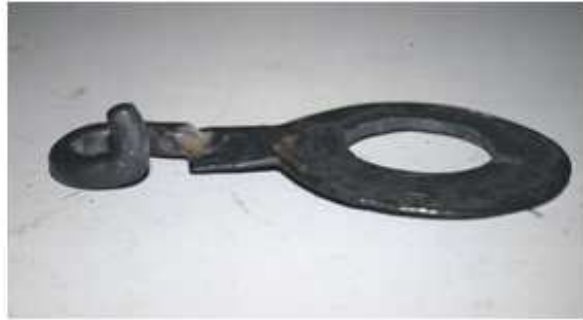
Bild 2: Seitenansicht der Lüzenscheibe
