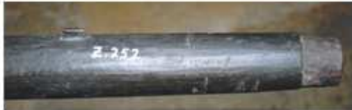
Bild 3: Richtbaumnase mit Nocken
