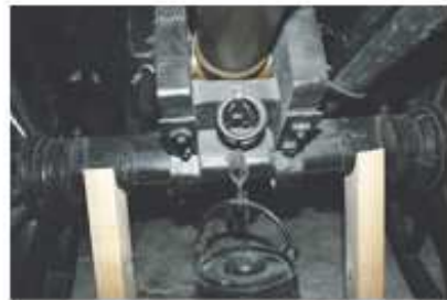
Bild 3: Brustriegel und Achse-Befestigung
