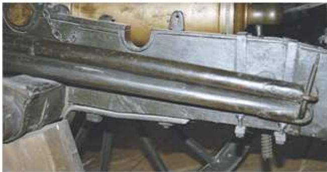
Bild 5: Halterung der Richtbäume an der Lafettenwand
