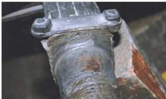
Bild 4: Kurzes Oberband, Stoss, Eisenband der Mittelachse
