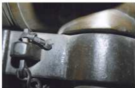
Bild 4: eingesetzter Keil, gesichert
