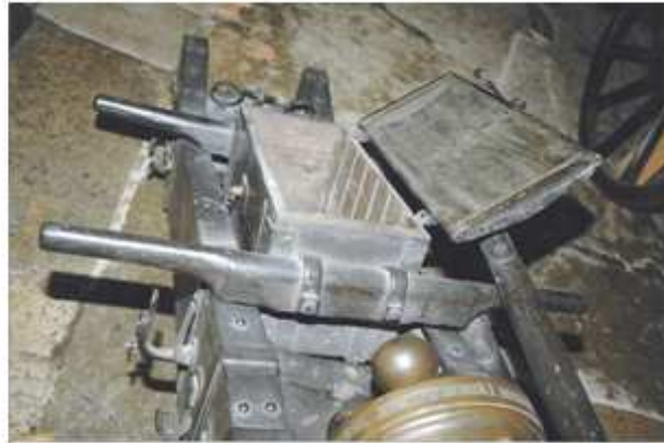
Bild 2: Munitionskiste auf Lafette und geöffnet
