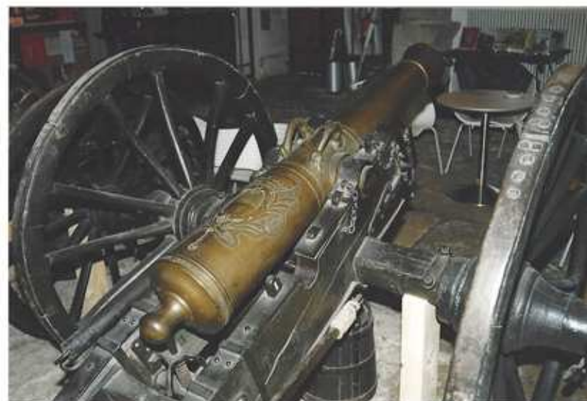
Bild 1: Bronze leichtes 4 Pfd.-Rohr von 4 Fuss 6 Zoll und 608 Pfund Gewicht
