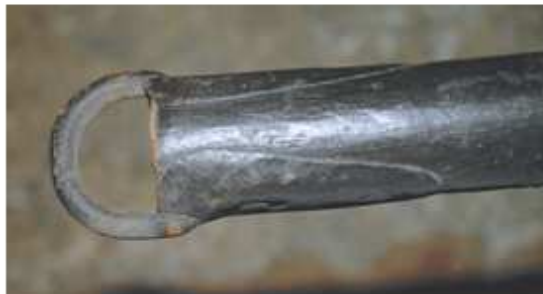
Bild 6: Halterungs-Öse am Richtbaum-Ende
